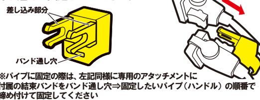
※パイプに固定の際は、左記同様に専用のアタッチメントに付属の結束バンドをバンド通し穴⇒固定したいパイプ(ハンドル)の順番で締め付けて固定してください
